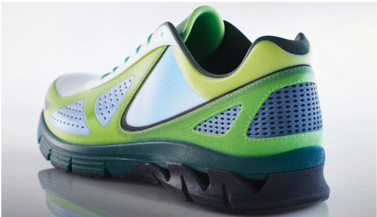
图 1: 这只全彩多材料鞋子使用 3D 打印整只打印, 包含一系列肖氏硬度值 (A)
