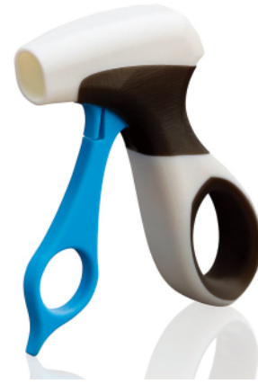
图 7：数字 ABS Plus 材料在用于医疗设备的设计验证原型中占到很大比重。该手术器械原型也采用黑色 Agilus30 包覆成型以实现卓越的抓握性，并具有 3D 打印的彩色手柄（单独打印）。Digital ABS Plus 材料在 Digital ABS 材料的基础上提升了冲击强度，以改善功能性能。
