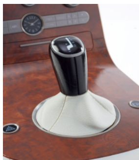
该原型汽车控制台上的木纹、人造革变速器罩及复杂表盘在 Stratasys J750 上通过单次打印而成。
